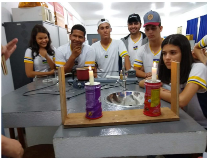
Figura 5.6: Aplicação do experimento da dilatação térmica com fio de cobre em sala de aula.
